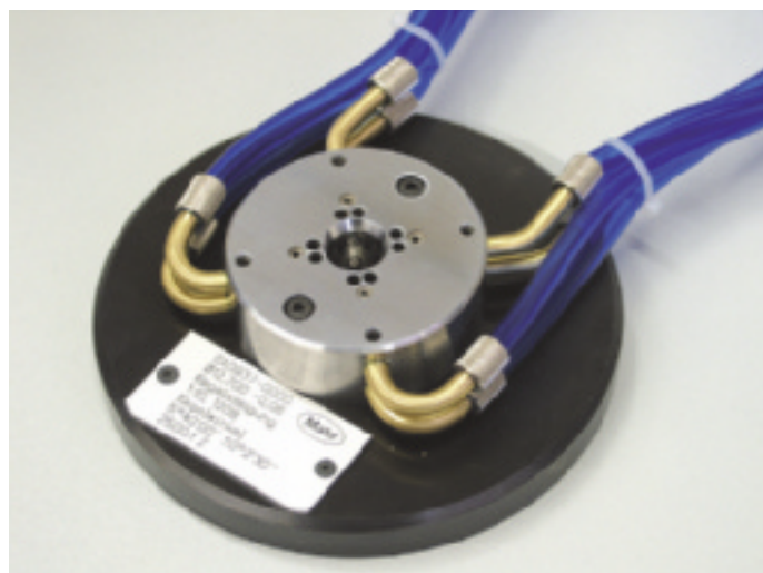
Anello pneumatico conico con 2 sezioni di misura su 2 livelli per il controllo di 4 diametri, 2 conicità e 2 distanze del cono
