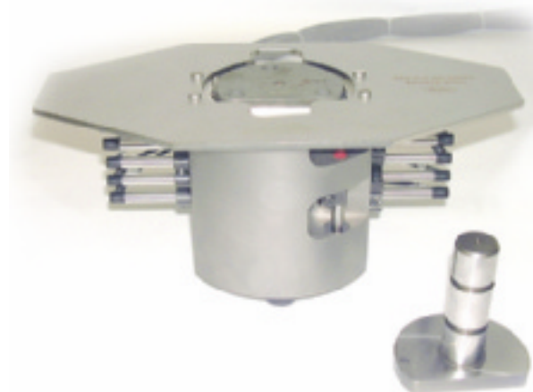
Strumento di misura elettronico per il controllo di 6 diametri e perpendicolarità
