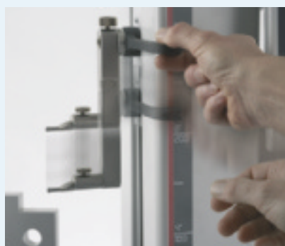
Ill. 1. Muovere il carrello di misura manualmente in direzione del pezzo da misurare.
