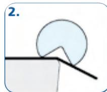
Il naturale movimento rotativo dell'attrezzo dà la forma al materiale seguendo la linea del cuneo, con minore pressione e distorsione del materiale rispetto ad un attrezzo a strofinamento.
