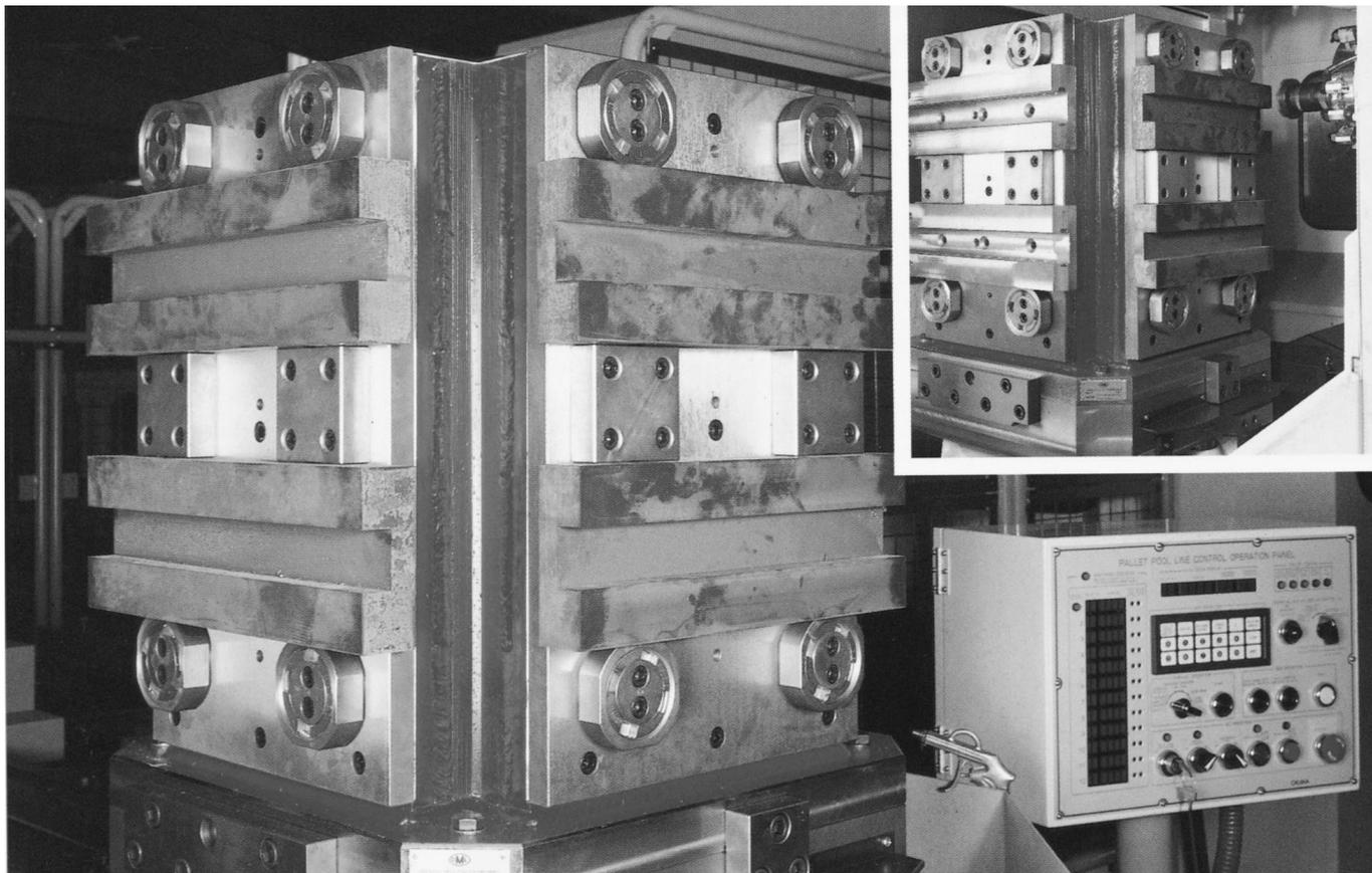
Il dispositivo di bloccaggio eccentrico irreversibile CAM SYSTEM è stato progettato e brevettato per soddisfare, in modo semplice le esigenze di bloccaggio sicuro di pezzi dalle forme più svariate .
