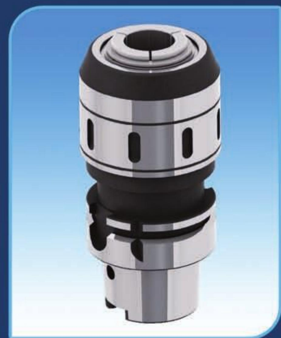
das Klemmdrehmoment und die hohe Steifigkeit erreicht. Der Rundlauf bleibt stabil, da ein Durchdrehen des Schaftes durch die neu angeordneten Axialnuten nicht mehr auftreten kann (verbleibende Ölreste beeinflussen die Klemmung nicht). Ein ruhiger Lauf, auch bei schwerer Zerspanung wird somit erreicht. Zentrale Kühlmittelzuführung ist möglich.
