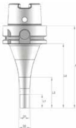
Micro mandrino di precisione. Modello dal design molto sottile perfetto per applicazioni in aree di lavoro di difficile accesso o spazi limitati. Grande forza di serraggio e alta precisione garantita dal ridotto angolo di conicità. Il serraggio delle pinze avviene dalla parte posteriore del mandrino con chiave esagonale inclusa.
