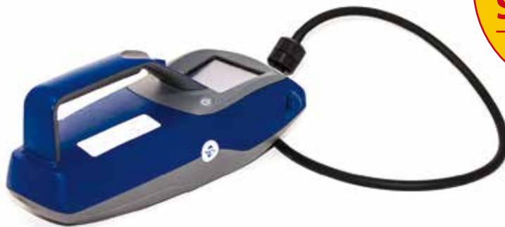
Il check up viene eseguito con **DustTrak™**, uno strumento che permette di fornire un'indicazione sulla concentrazione degli inquinanti in fase di lavorazione della macchina utensile.
