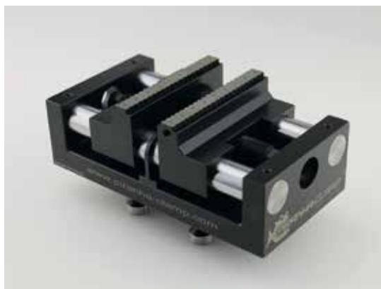
Le ganasce hanno due file di denti da 3 mm, la fila inferiore applica una forza verso il basso (pull-down) mentre la fila superiore tiene il pezzo in posizione.
