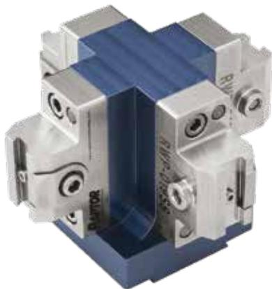
Il mini cubo Raptor utilizza 4 morse a coda di rondine RWP-019SS da 0.375" montate con un angolo di 90 gradi. Ha una base a coda di rondine da 1.5" e si fissa su altre morse Raptor per un ricambio facile e veloce. I tempi di lavorazione vengono ridotti e **la produttività della vostra macchina viene drasticamente aumentata.**
