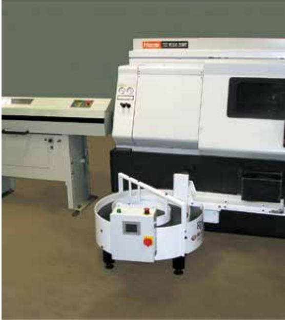
■ Equipaggiare il vostro tornio CNC con il Royal Rota-Rack vuol dire eliminare i rischi di danneggiamento dei pezzi ma soprattutto Vi farà guadagnare ore extra di lavoro al giorno, senza la necessità di presenziare la macchina!
