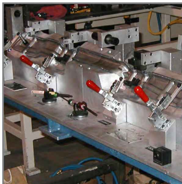
Modello 210-U usato in un calibro di controllo.
