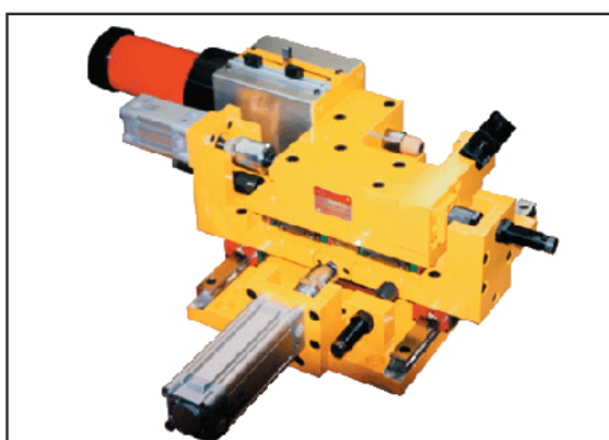
Attrezzo speciale per 2 fori Ø 12 in acciaio da 1,2 mm
