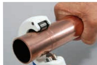
Il tagliatubi Multi 67 può essere utilizzato su tubi in plastica e multistrato con diametro massimo di 67 mm e su tubi in rame o acciaio inossidabile.
