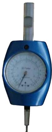
Centrocomparatore 3D economico: Lettura centesimale per determinare il punto "0" su ogni asse di lavoro della MU (orizzontale, longitudinale, verticale)
