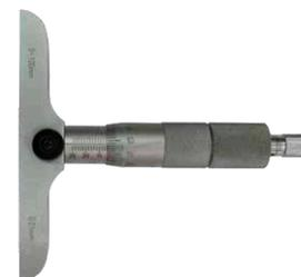
**Art. SA050DGT – Micrometri digitali di profondità con aste intercambiabili lett. 0,001mm**
