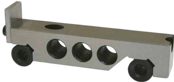
I barraseni permettono di calcolare piani inclinati con l'angolazione desiderata. E' un sistema di altissima precisione e consiste nel posizionare un blocchetto pianparallelo sotto uno dei cilindri.
